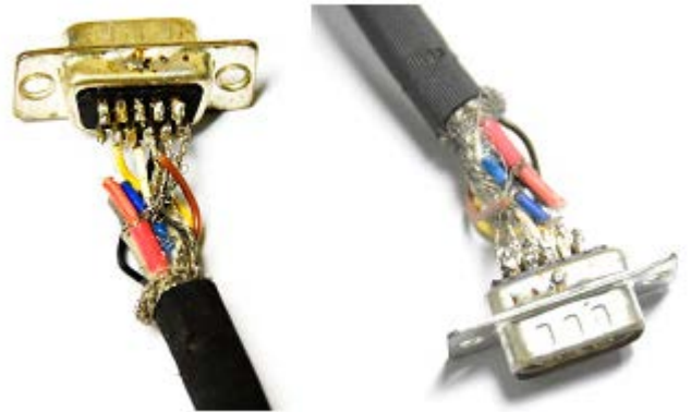
รูปที่ 5 แสดงการชำรุดของสาย VGA
